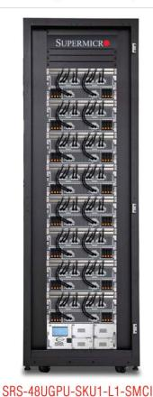
Up to 8 GPU servers (4U, 8 NVIDIA H100/ H200 GPU per sever) per 48U rack (64 NVIDIA H100/200 GPUs per rack
